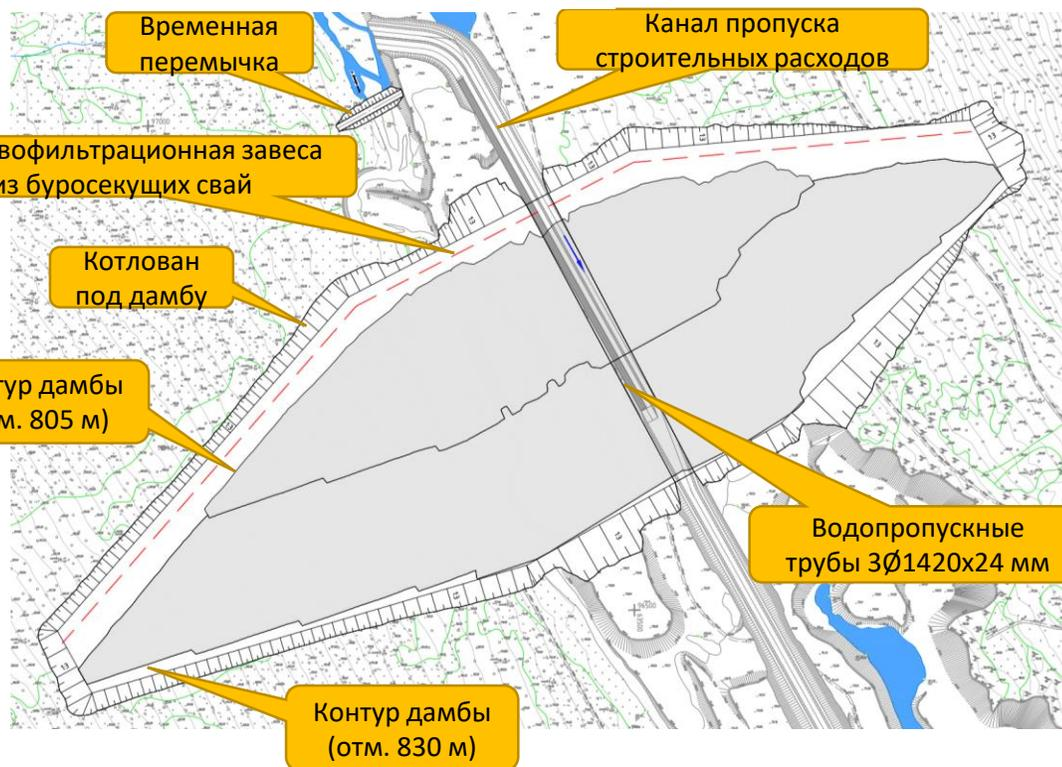
Выемка техногенных некондиционных грунтов и сильнольдистых грунтов из-под основания предусматривается только под площадью дамб до отм. 830,0 м с заменой на скальный грунт.
